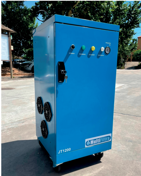
Imagen del equipo experimental que ha obtenido unos resultados excelentes. Los equipos definitivos en producción serán realizados en acero al carbono con recubrimiento total de PU y existirá la opción de acero inoxidable.
